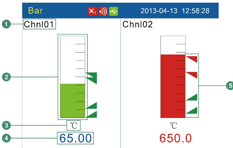
1. Channel tag. See section 『Channel Tag and Unit Setting』
