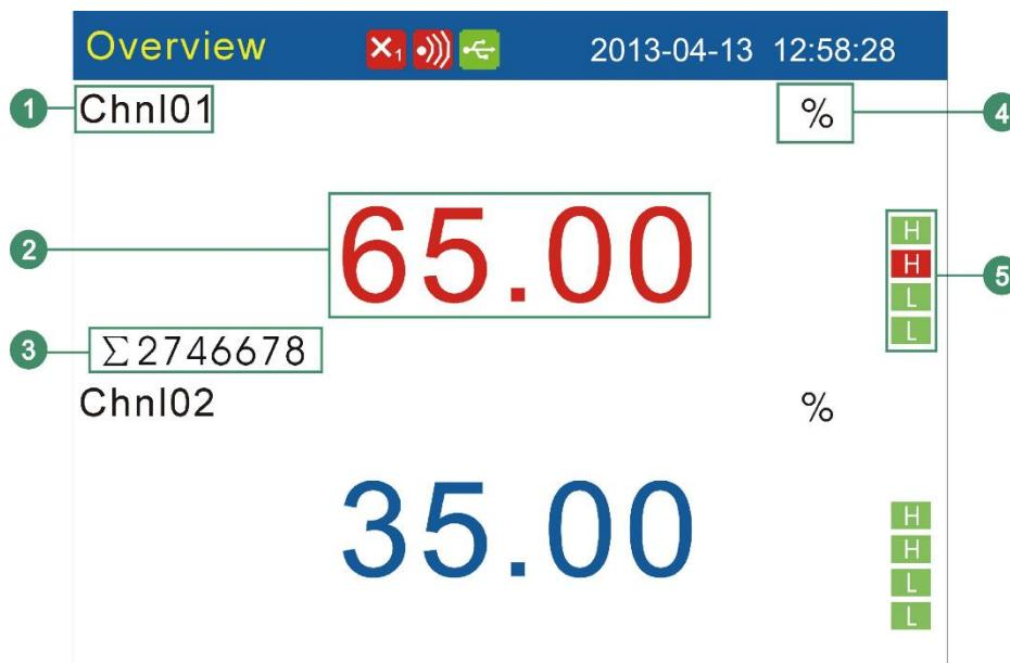
1. Channel tag. See section 『Channel Tag and Unit Setting』
